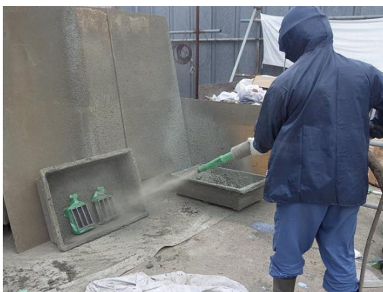
写真－5.1.5 圧縮試験用型枠への吹付け ( 40\times 40\times 160\text{mm} )
