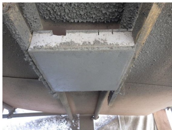
写真－5.1.7 上面付着供試体採取完了
