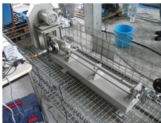
写真-3.2.2 試験に使用したスネーク式ポンプ (兵神装備株式会社製 ヘンシンモノポンプ 12NE15PM 型)
