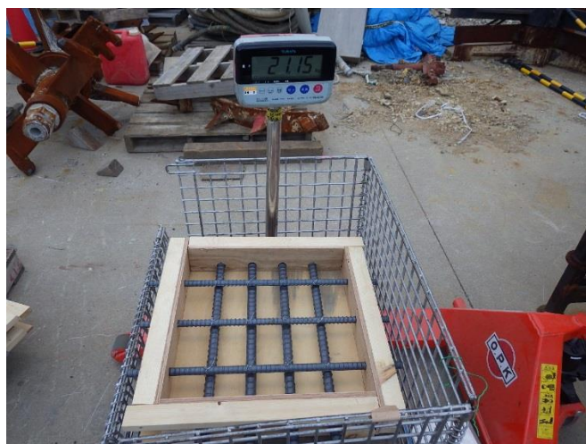
写真－5. 1. 3 上面吹付け型枠の外観
