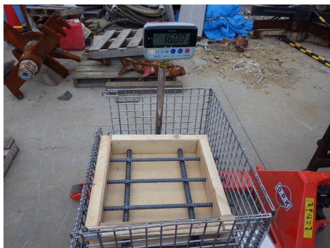
写真－5. 1. 2 側面吹付け型枠の外観
