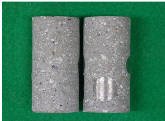
写真－5.1.10 側面吹付け鉄筋背面コア
