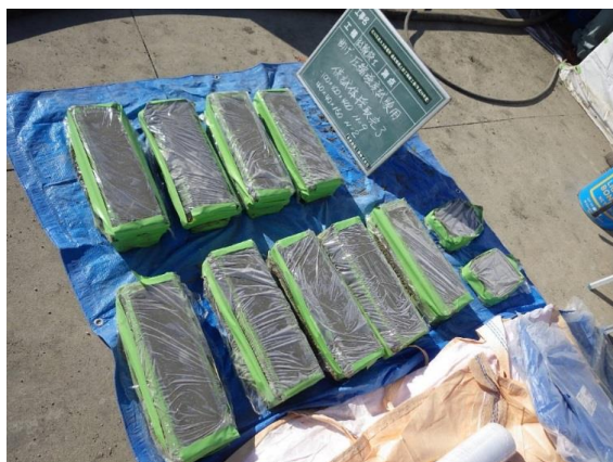
写真－5.1.6 供試体採取完了 ( 100\times 100\times 400\text{mm} )
