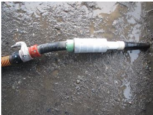
写真-2.1.7 ノズル内部構造を工夫した一例
